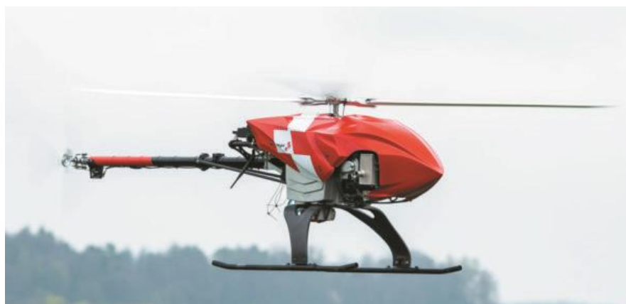
Рис. 2.17. Рятувально-пошуковий дрон швейцарської авіаційно-рятувальної організації Rega, який самостійно шукає людей
