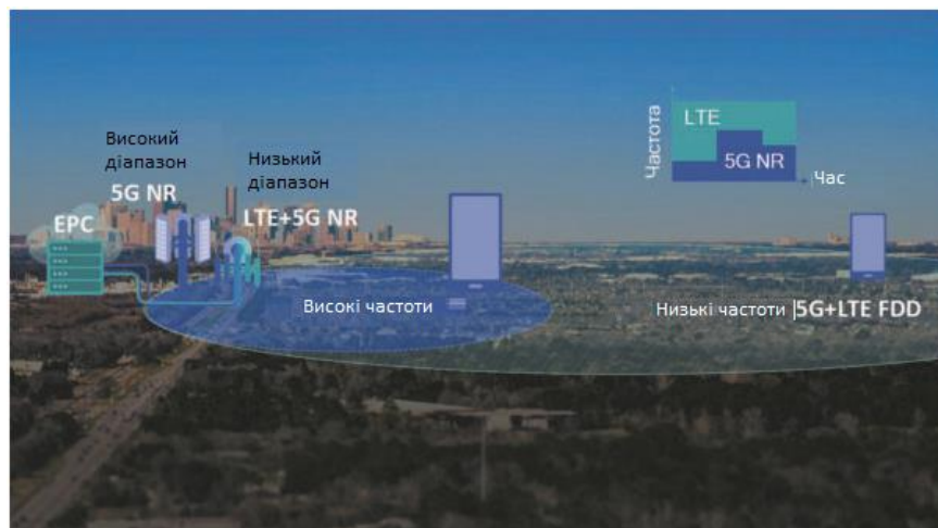
Рис. 2.24. Розширення покриття 5G з низькими частотами LTE (DSS)
