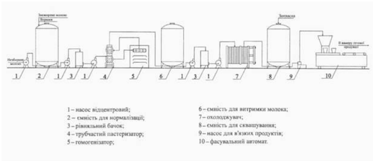
Рис. 3.4. Апаратно-технологічна схема лінії з виготовлення кефіру з додаванням біологічно активної добавки «Йодіс-концентрат»
