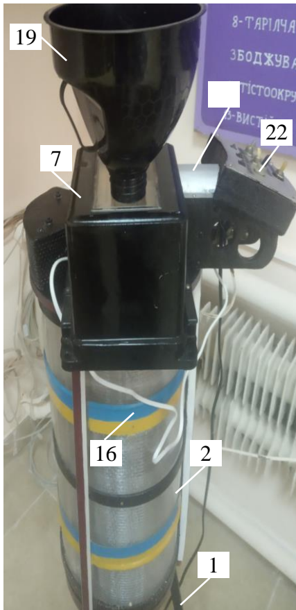
Рисунок 2.3 – Схема та загальний вигляд лабораторної установки: а, б – відповідно, конструктивна схема та 3D (б) модель дискретно-імпульсного змішувача компонентів; в – загальний вигляд лабораторної установки; г – загальний вигляд тарілчастих дисків і мішалки; д – загальний вигляд дозатора водно-дріжджової суспензії
