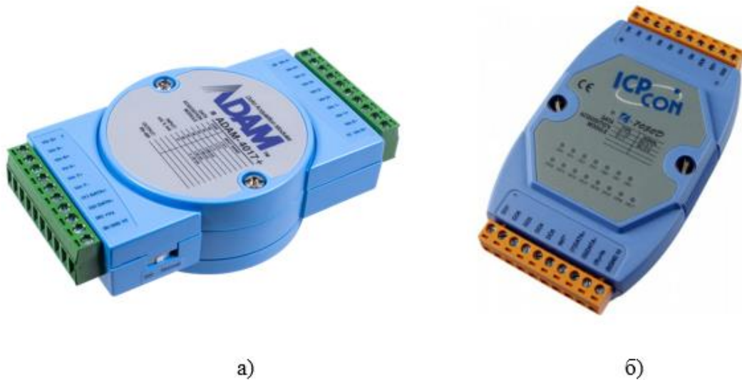
Рисунок 3.7 – Модулі серій ADAM-4000 (а) та I-7000 (б)
