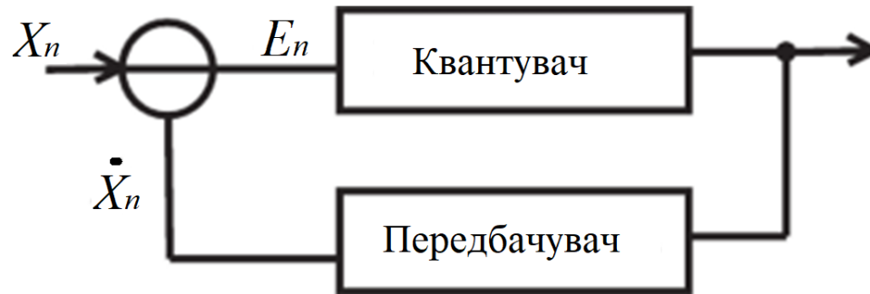
Рис. 1.4. Схема, яка пояснює алгоритм диференціальної імпульсно-кодової модуляції
