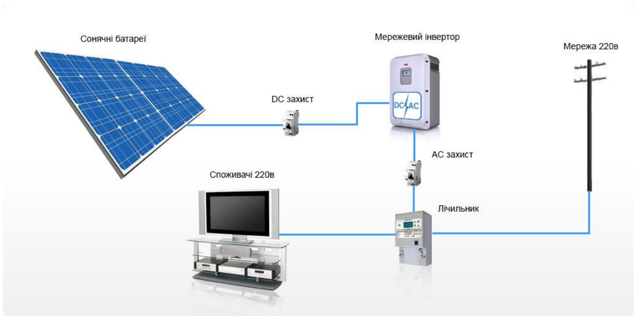
Рисунок 1.3 – Структура сонячної фотоелектричної станції
