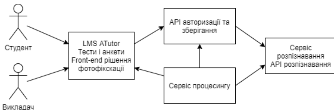
Рис. Схема архітектури модуля фотофіксації та розпізнавання
