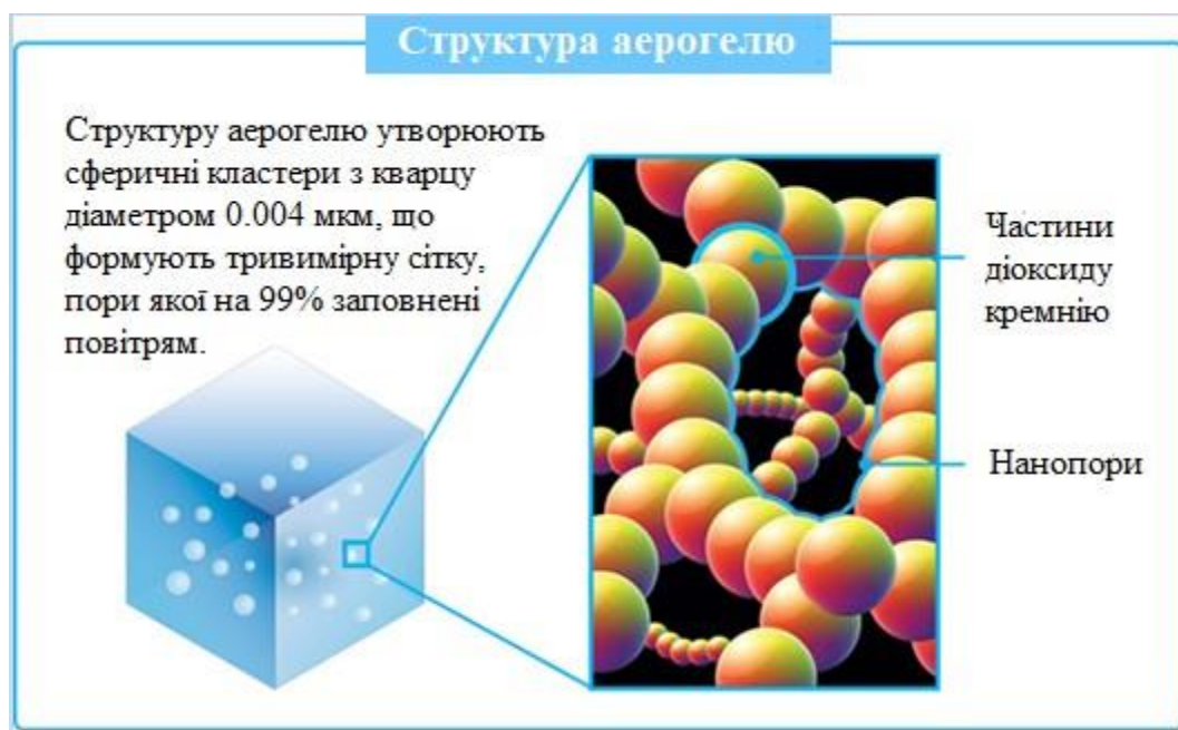
Рисунок 1. Внутрішня структура аерогелю
