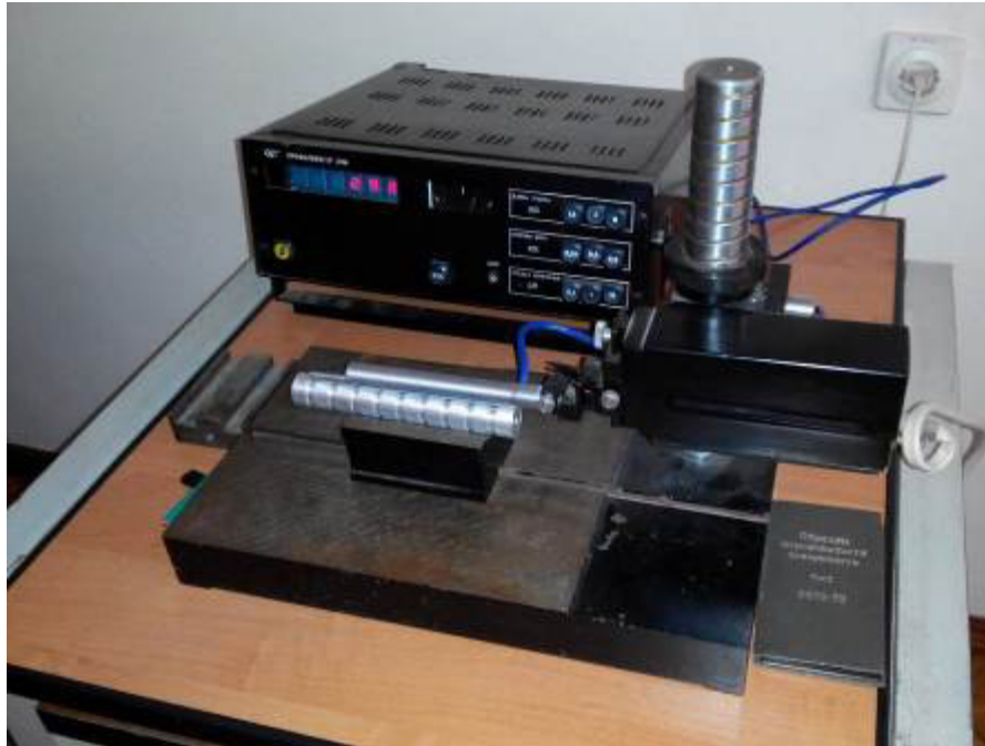
Рисунок 2.14 – Визначення параметрів шорсткості на профілометрі моделі 296
