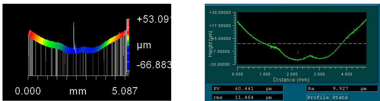
Рисунок 4.6 – Поперечні перерізи канавок зношування канавка з подвійною вершиною зношування
