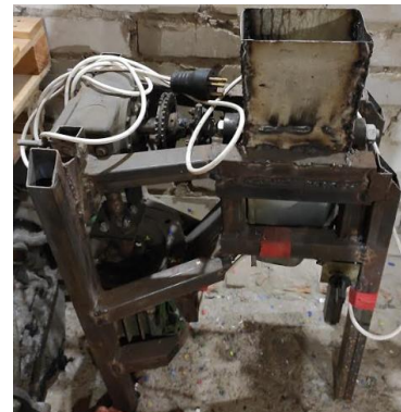
Рис. 1 Загальний вигляд установки для подрібнення твердих полімерних матеріалів
