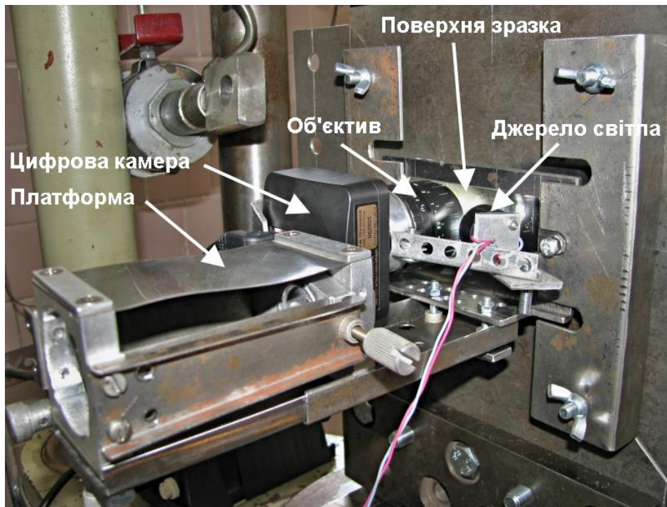
Рис. 3.11 – Оптична система для ЦКЗ на установці для двовісного навантаження хрестоподібних зразків на основі промислової цифрової камери TourTek UCMOS 10000KPA.
