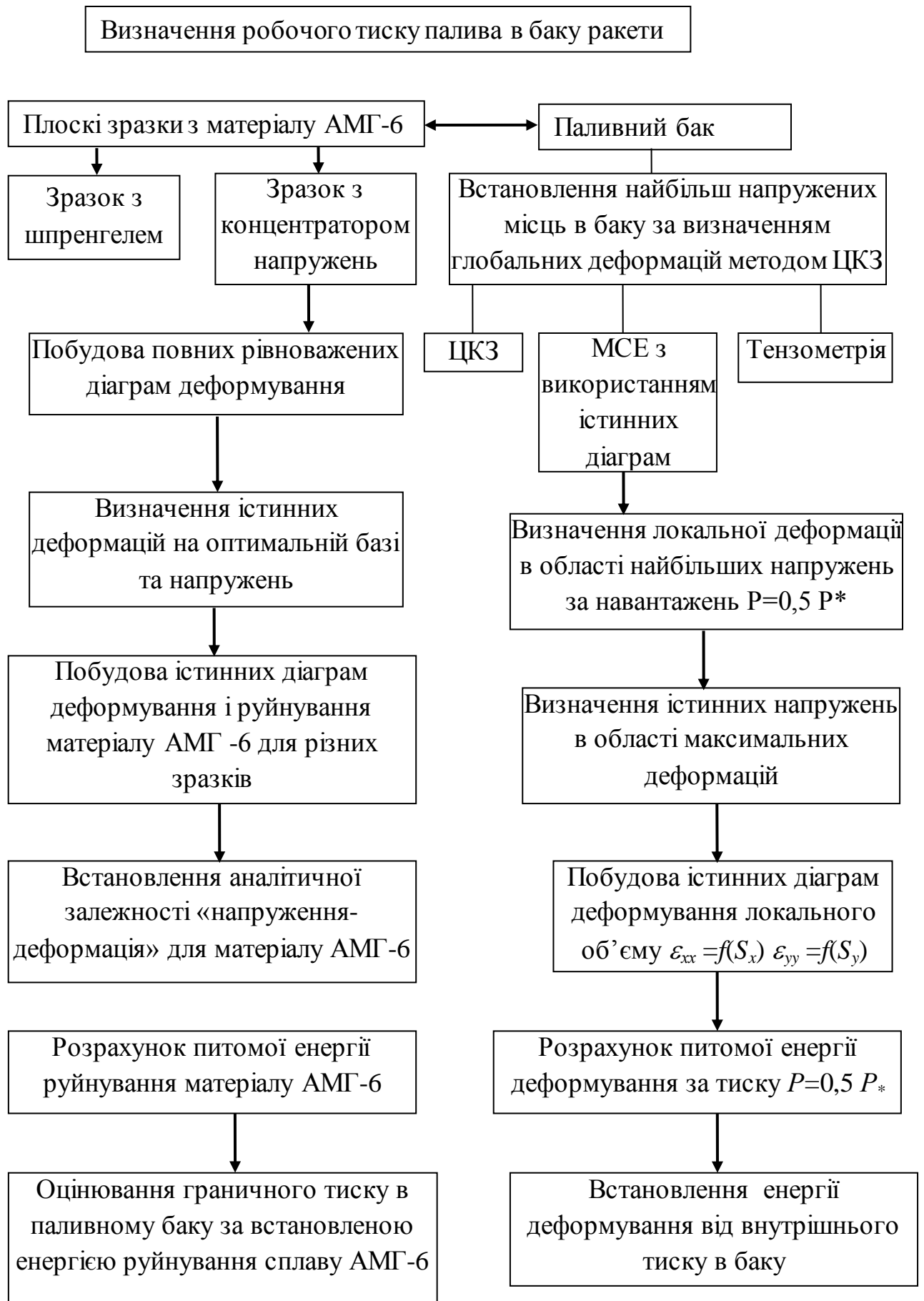
Рис. 3.1 Схема визначення допустимого робочого тиску у паливному баку
