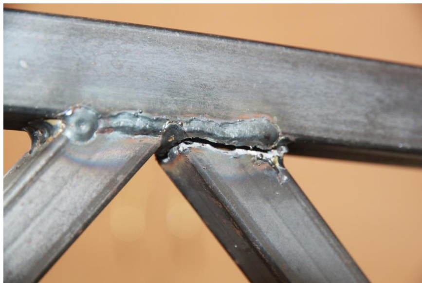
Рисунок 4.4 – Лівий проміжний К-подібний вузол з тріщиною
