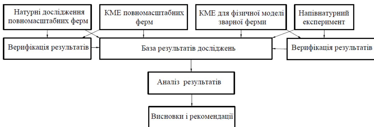
Рисунок 2.14 – Структурна схема дослідження K-подібних вузлів зварних ферм
