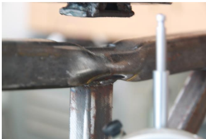
Рисунок 3.35 – Наслідок локального пошкодження фізичної моделі зварної ферми
