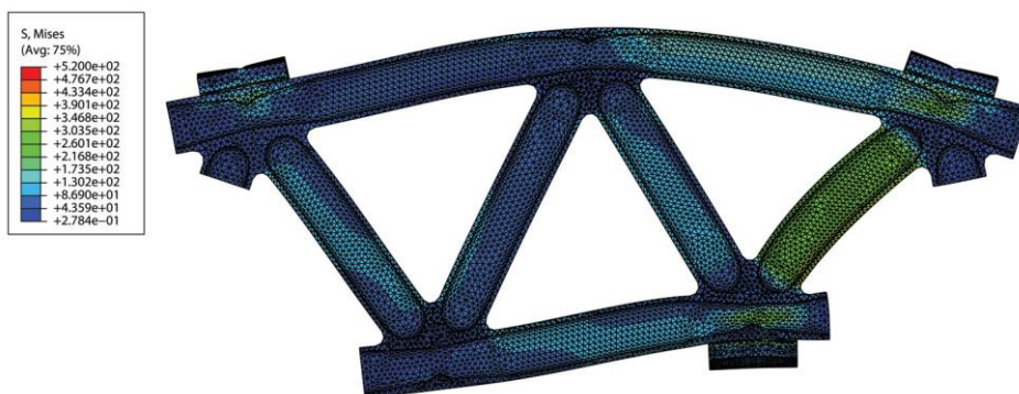
Рисунок 1.21 – Напруження в фермі з круглої труби [80]
