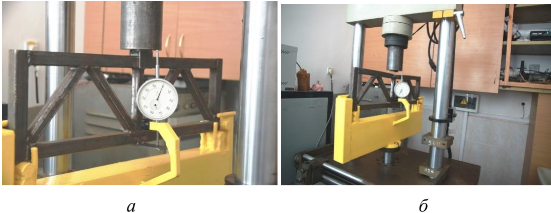
Рисунок 3.34 – Фізична модель зварної ферми перед прикладанням статичного навантаження ( а ) та після локального пошкодження ( б )
