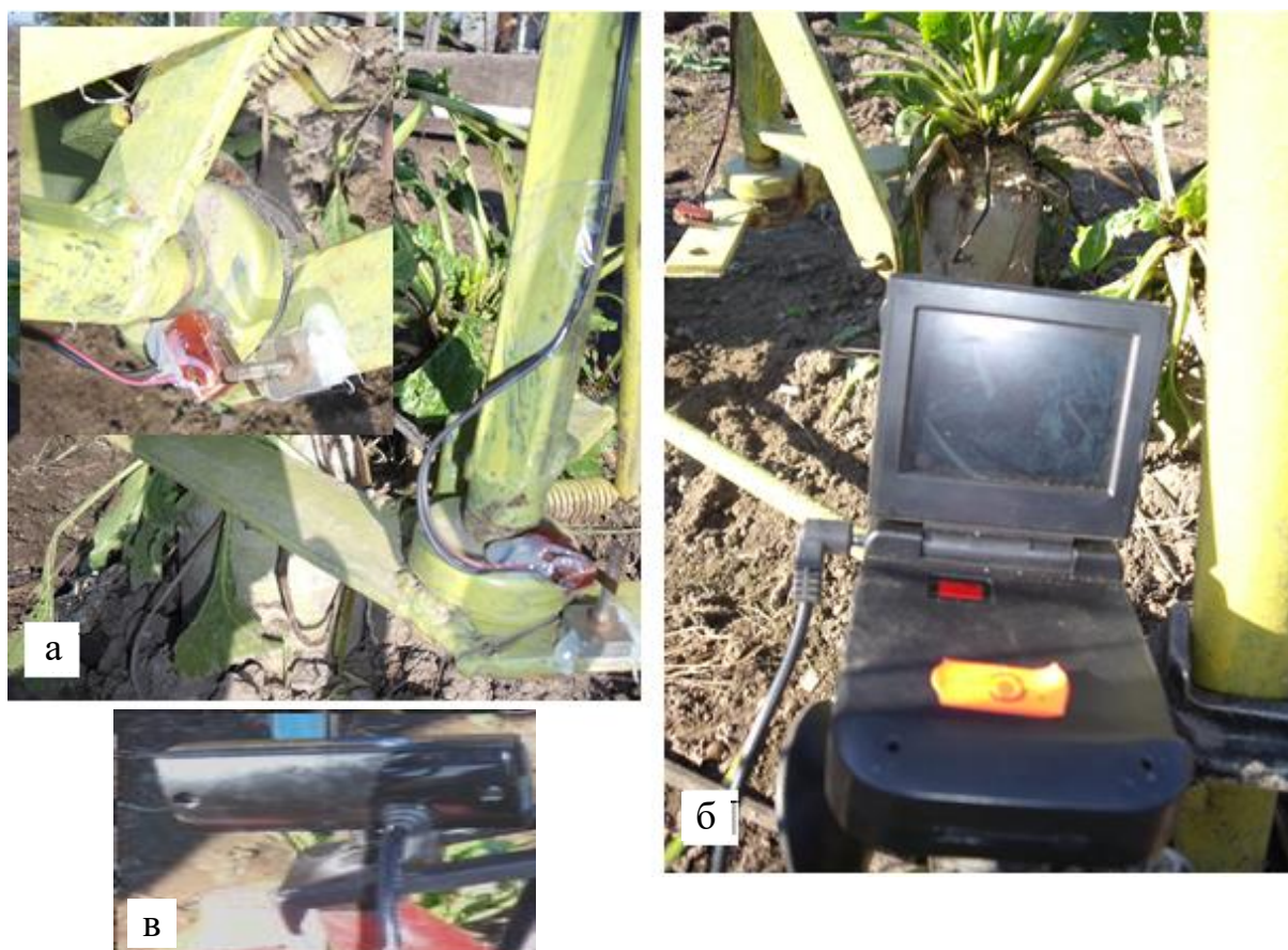
Загальний вигляд: а – контактний мікроперемикач; б – відеореєстратор; в – мультимедійна швидкісна відеокамера
