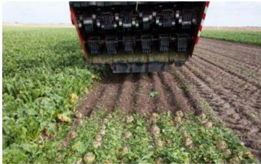
Рисунок 1.11 – Розкидання зрізаної гички у міжряддя незібраних коренеплодів
