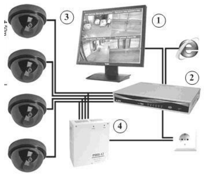
Рисунок 2.2 – Типова схема відеоспостереження з відеореєстратором
