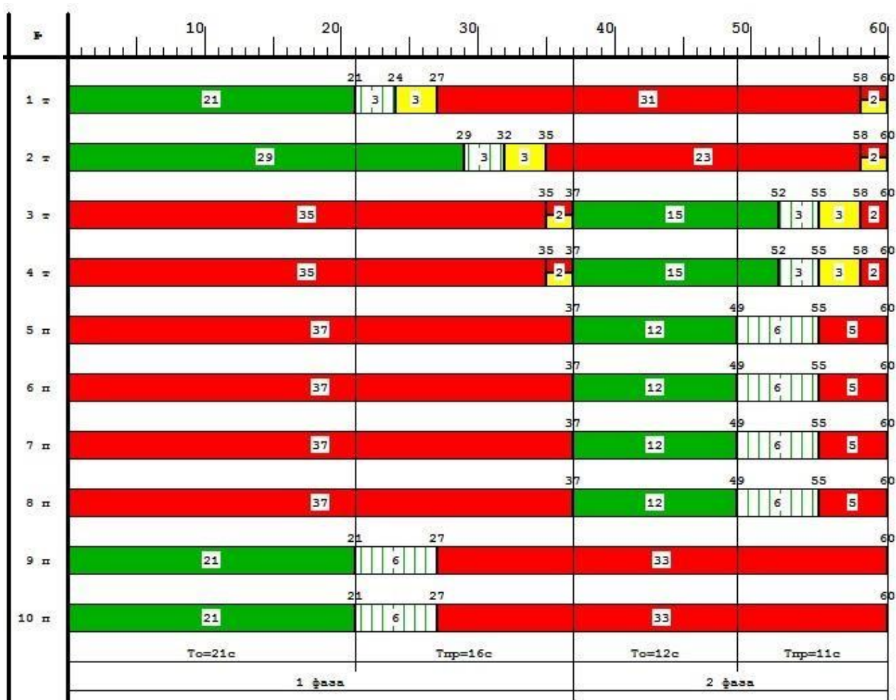
Рисунок 2.1 – Пропонована діаграма світлофорного регулювання на перехресті вулиць Кульчицької і Насінна
