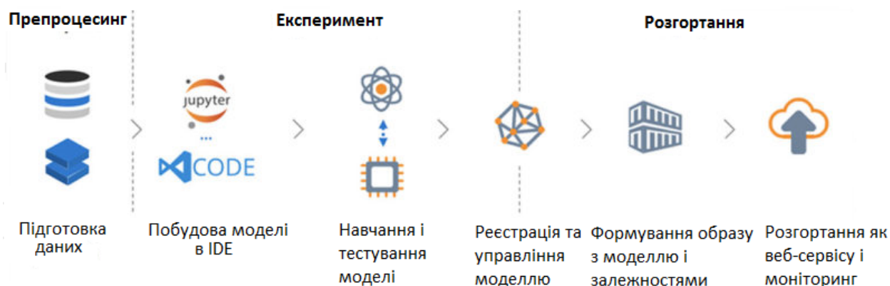
Рисунок 2.1 – Загальний процес побудови комп'ютеризованої системи формування ціни на нерухомість з використанням Azure Machine Learning
