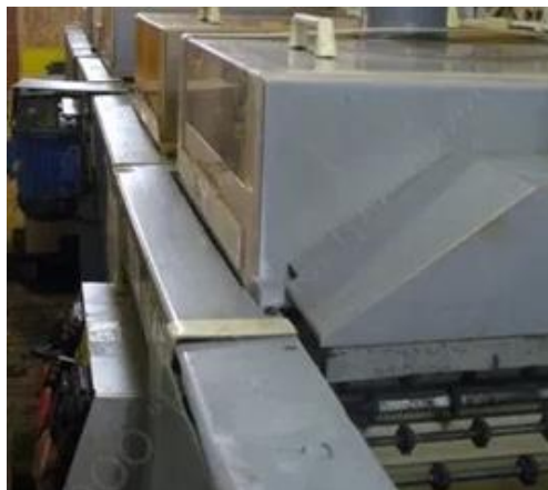
Рисунок 1.24 – Приклад конвеєрної установки для хімічної підготовки поверхні друкованих плат з вбудованими модулями промивання.
