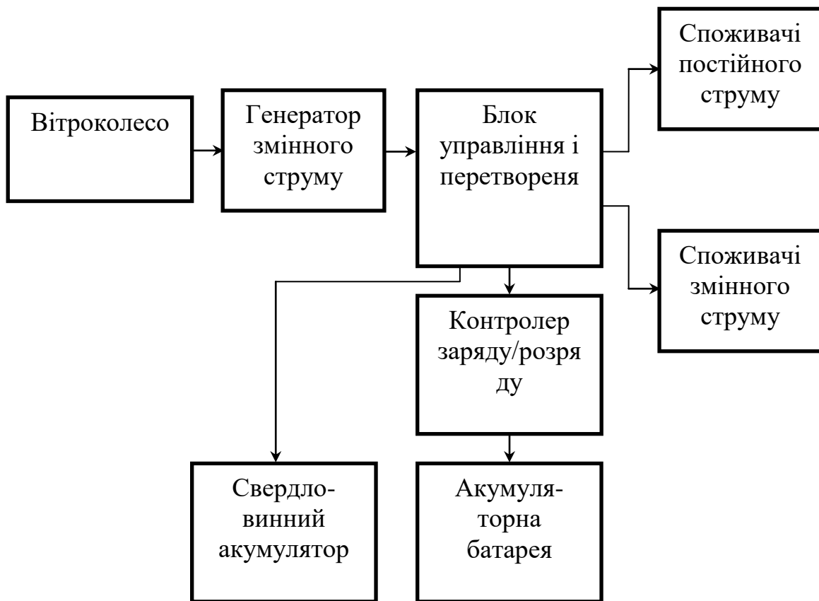
Рисунок 2.5 - Структурна схема автономної системи електропостачання на основі вітроенергетичної установки
