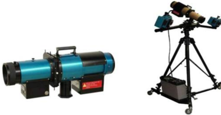
Рисунок 2.8 - Проектор Pro-SPOT на тринозі з камерами
