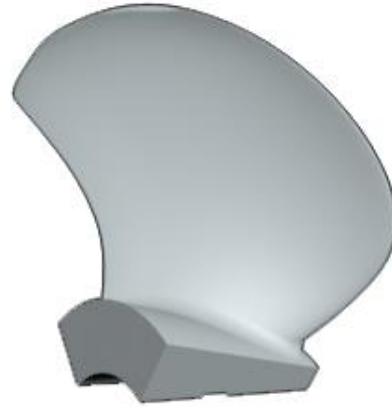
Рисунок 3.14 - Теоретична 3D-модель однієї лопасті гвинта
