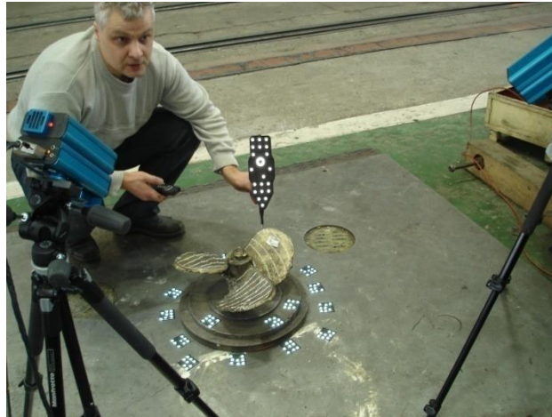
Рисунок 3.2 - Вимірювання просторових координат гребного гвинта за допомогою ручного щупа
