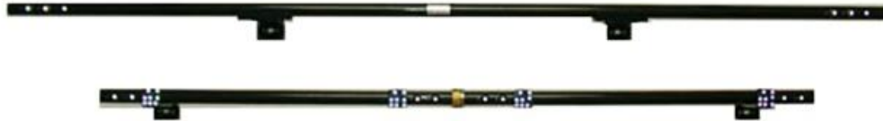
Рисунок 2.6 - Масштабна лінійка ScaleBar з базою 870 мм (одна половина) і 1840 мм (в зборі) в кейсі для перенесення
