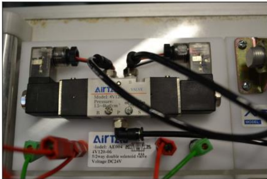
Рисунок 3.5 - 5/2 Подвійний електромагнітний клапан.
