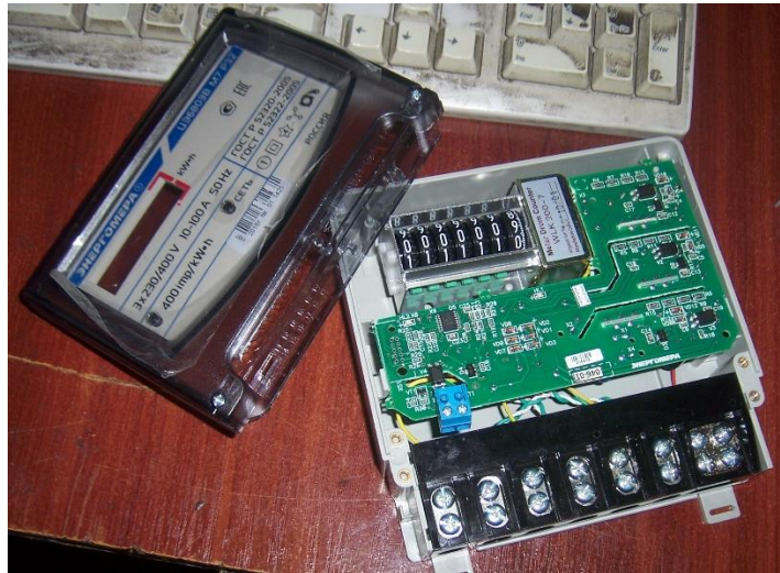
Рисунок 1.7 Будова електричного лічильника «Енергоміра ЦЕ6803В Р32»
