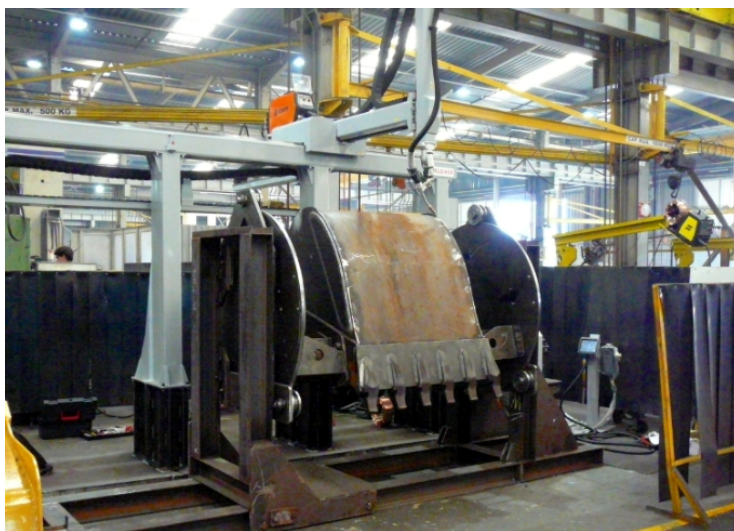
Рис. 1.5. KBWELD HD5 - 5-вісна роботизована система для зварювання ковшів екскаваторів та грейферів http://kiberys.com/robotic-systems-for- welding/automotive-welding/1-2/
