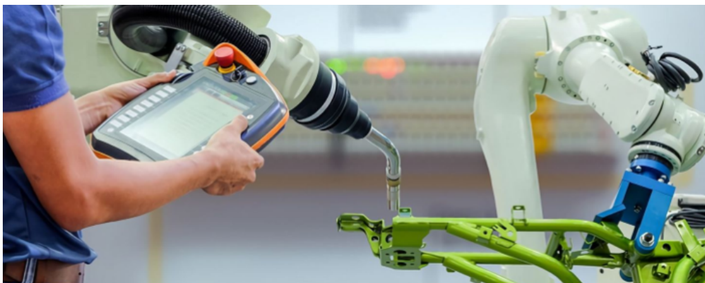
Рис. 1.2. Управління зварювальним роботом ( https://www.tws.edu/blog/skilled-trades/robotic-welder-operator-career-an-overview/ )
