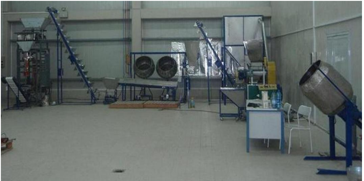
Рисунок 2.2 – Автоматизована лінія виробництва кукурудзяних паличок
