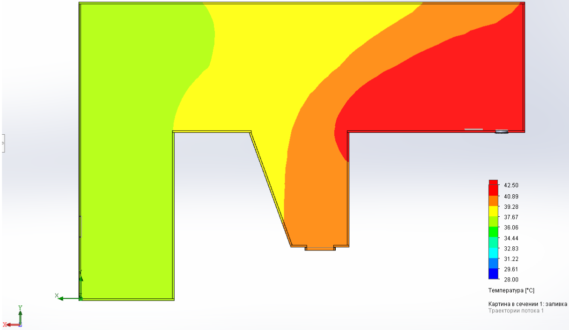
Рис. 4.17. Результаты моделирования температуры у потоці повітря при вистоюванні тiстових заготовок в шафі А2-ХРЗ, °С (вертикальний зріз).
