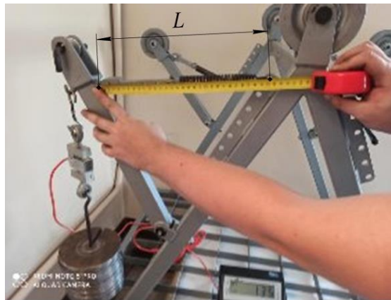
Рисунок 3.9 - Загальний вигляд проведення експериментальних досліджень для визначення залежності зміни F = f(\Delta L) та вимірювання довжини L
