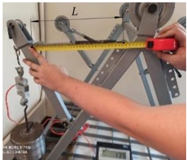
Рисунок 4.5 – Функціональні залежності зміни F = f(\Delta L) та вимірювання довжини L , а також загальний вигляд проведення досліджень для першої позиції пружини і F_{max} = 135 \text{ Н} та \Delta L_{max} = 26 \text{ мм}
