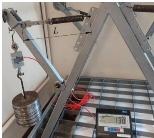
Рисунок 4.6 – Функціональні залежності зміни F = f(\Delta L) та вимірювання довжини L , а також загальний вигляд проведення досліджень для першої позиції пружини і F_{max} = 135 \text{ Н} та \Delta L_{max} = 30 \text{ мм}
