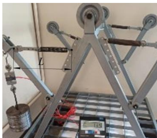
Рисунок 4.7 – Функціональні залежності зміни F = f(\Delta L) та вимірювання довжини L , а також загальний вигляд проведення досліджень для першої позиції пружини і F_{max} = 135 \text{ Н} та \Delta L_{max} = 34 \text{ мм}
