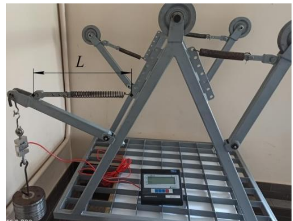
Рисунок 4.11 – Функціональні залежності зміни F = f(\Delta L) та вимірювання довжини L , а також загальний вигляд проведення досліджень для першої позиції пружини і F_{max} = 123,75 Н та \Delta L_{max} = 110 мм
