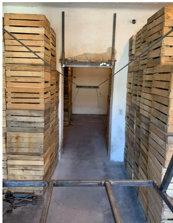
Рисунок 3.3 - Схема та загальний вигляд механізму для завантаження складських приміщень, які розділені між собою повздовжньою стіною
