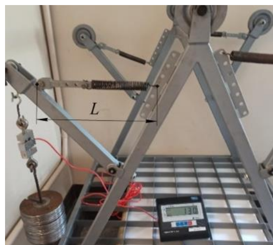
Рисунок 4.8 – Функціональні залежності зміни F = f(\Delta L) та вимірювання довжини L , а також загальний вигляд проведення досліджень для першої позиції пружини і F_{max} = 135 \text{ Н} та \Delta L_{max} = 46 \text{ мм}
