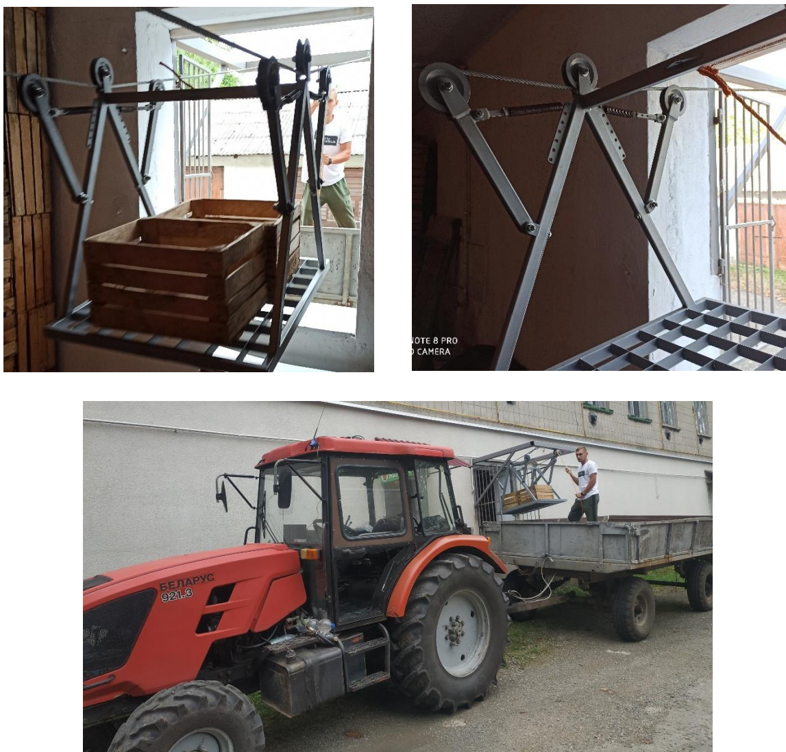
Рисунок 3.2 - Загальний вигляд зони завантаження штучних вантажів у складське приміщення
