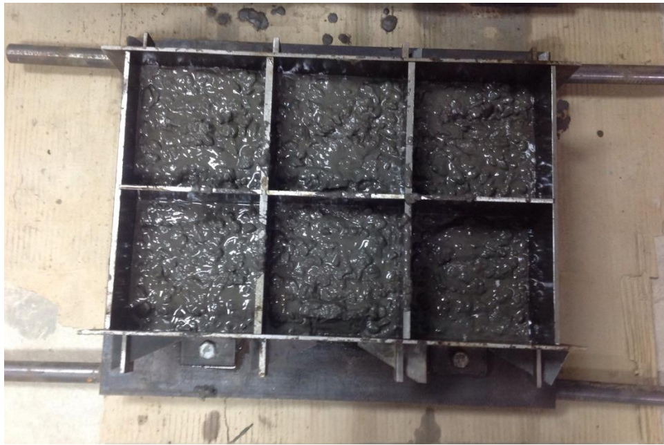
Рисунок 2.6 – Форма для кубів з бетоном
