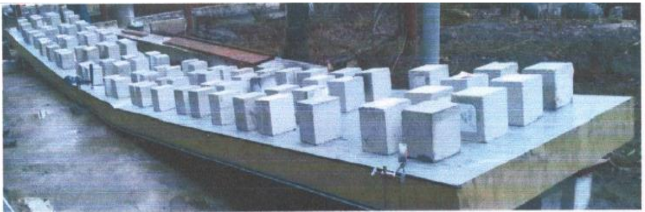
Рисунок 3.4 - Випробування стінової сендвіч-панелі СМСм (довжиною 9,5 м) з мінераловатним заповнювачем товщиною 150 мм
