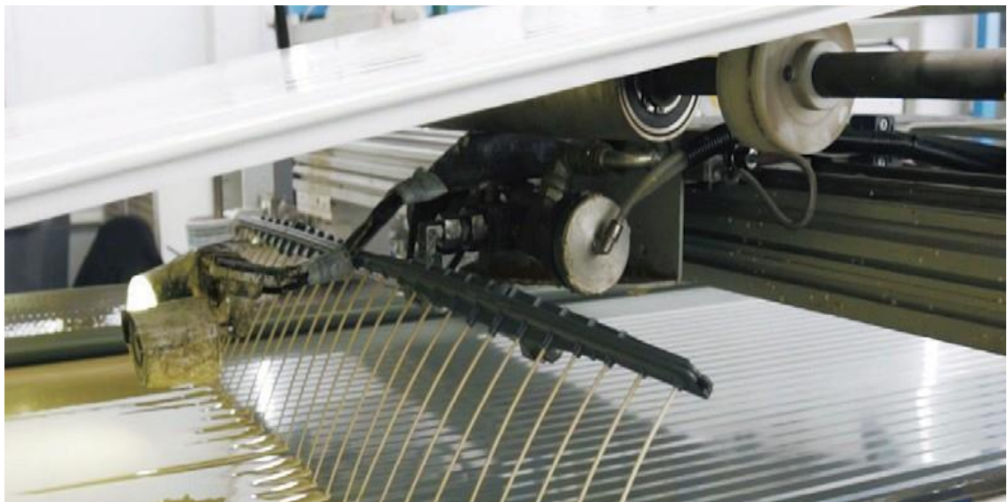
Рисунок 1.5 - Впорскування суміші компоненти (пінополіуритан) [2]
