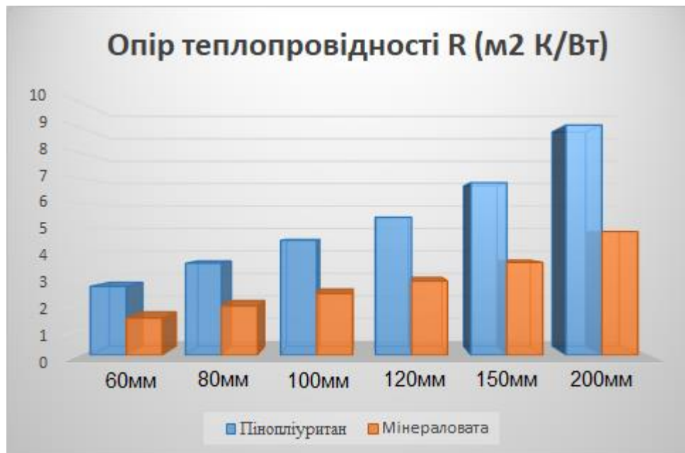
Рисунок 2.7 – Діаграма опору теплопровідності стінових сендвіч-панелей із наповнювачами пінополіуритан та мінераловата
