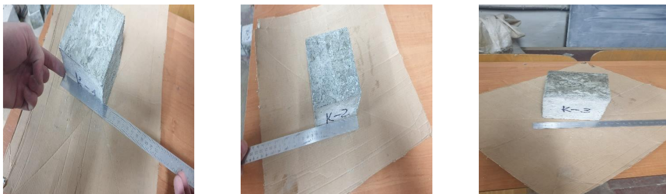
К-1 – кубик без добавок; К-2 – кубик з добавкою Д-1; К-3 – кубик з добавкою Д-2.
