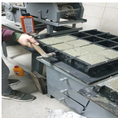
Рисунок 2.5 – Процес виготовлення бетонних кубиків (пояснення в тексті)
