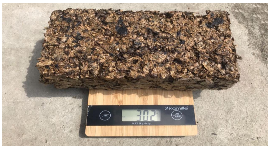
Рисунок 3.2 Зразок для дослідження на основі листя дерев з рідким склом
