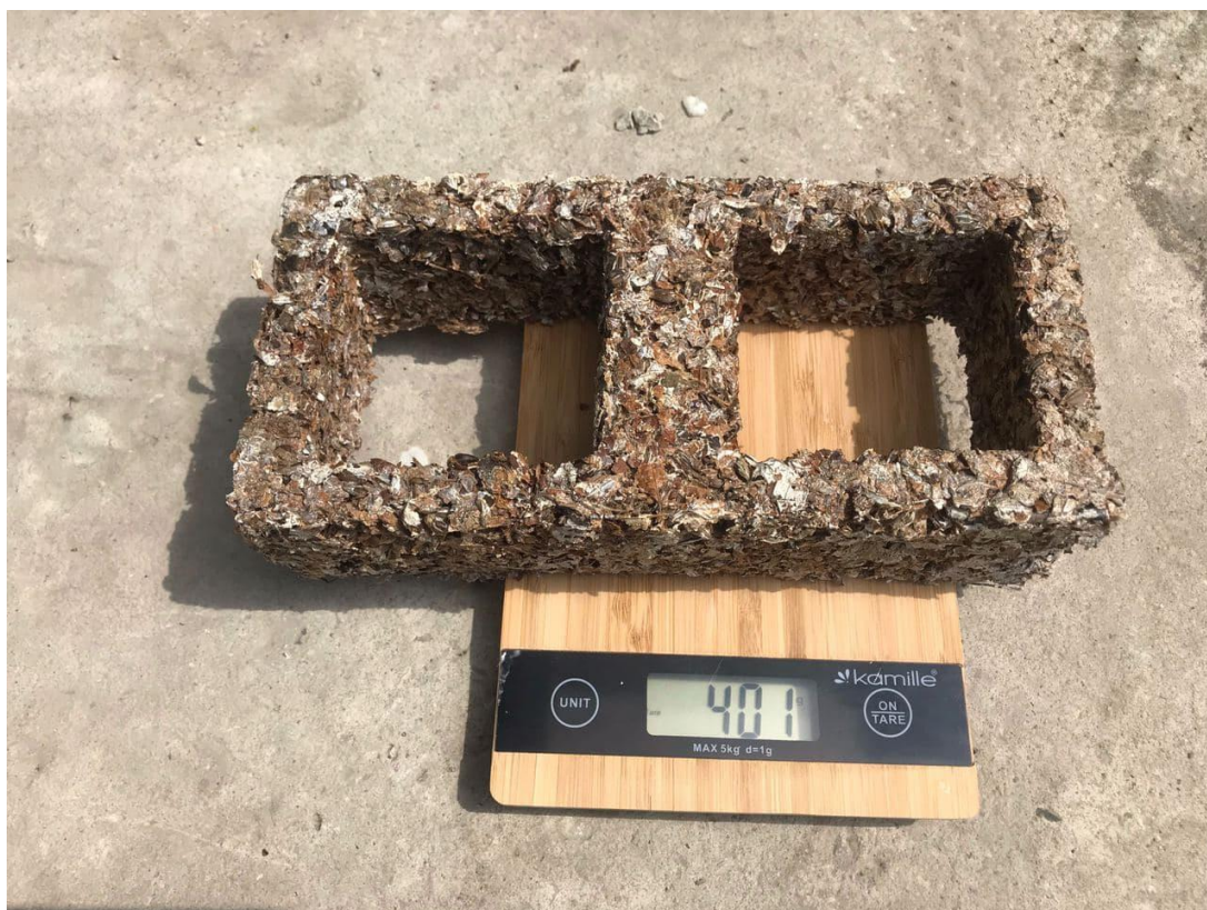
Рисунок 3.8 Зразок для дослідження пустотілих на основі листя дерев у поєднанні з рідким склом
