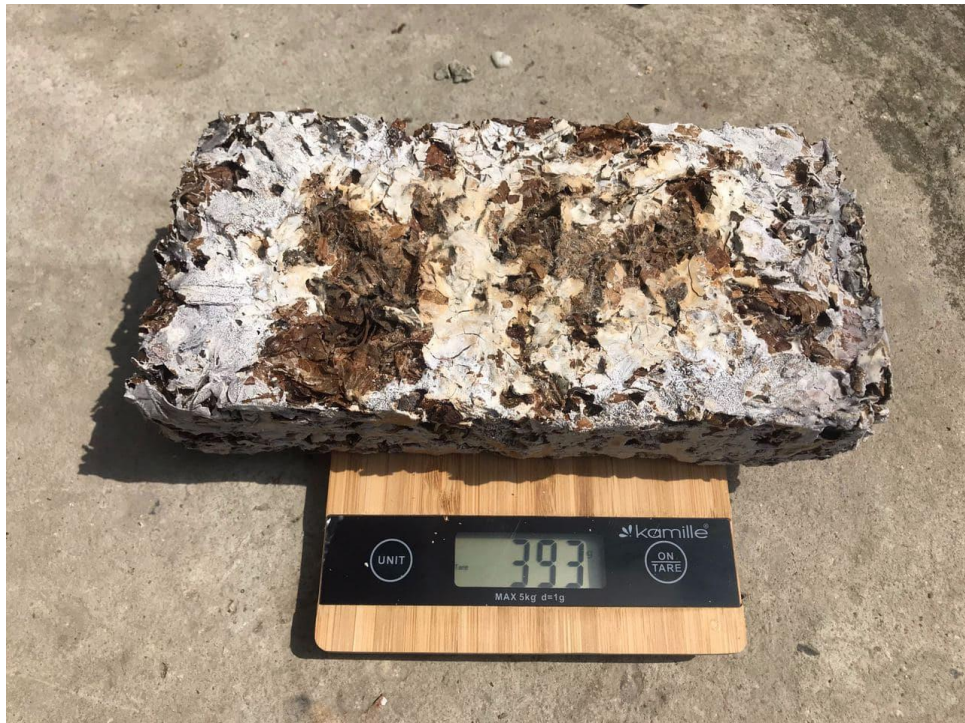
Рисунок 3.4 Зразок для дослідження на основі листя дерев з клеєм ПВА
