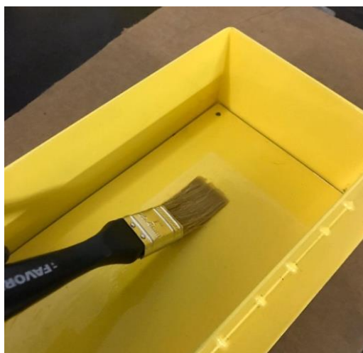
Рисунок 2.4 – Змащування форми машинним маслом для запобігання адгезії
