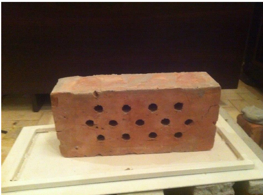
Рисунок 3.1 – Зразок висушеної керамічної цегли з круглими пустотами
