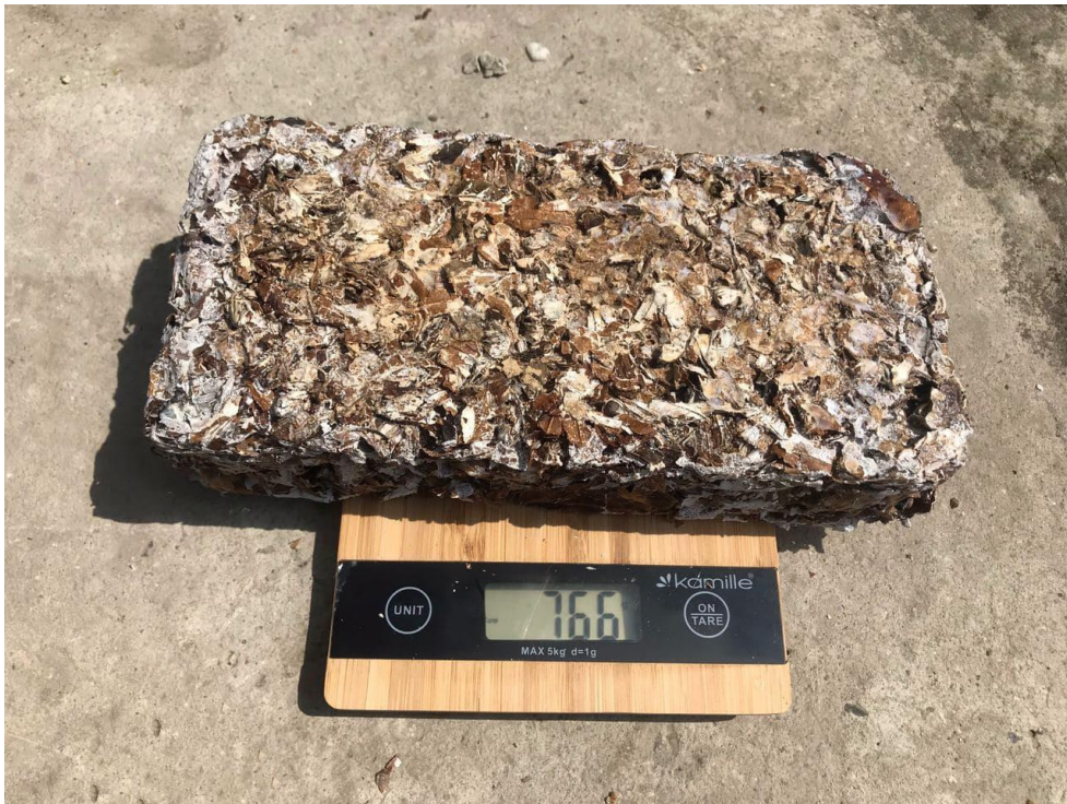
Рисунок 3.6 – Зразок для дослідження на основі листя дерев у поєднанні з вапном
