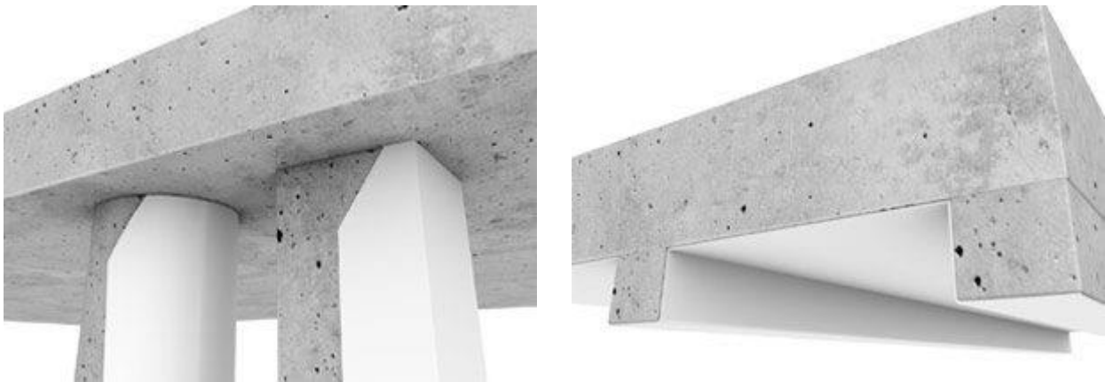
Рисунок 2.2 – Приклад нанесення вогнезахисної фарби на колони та балки
