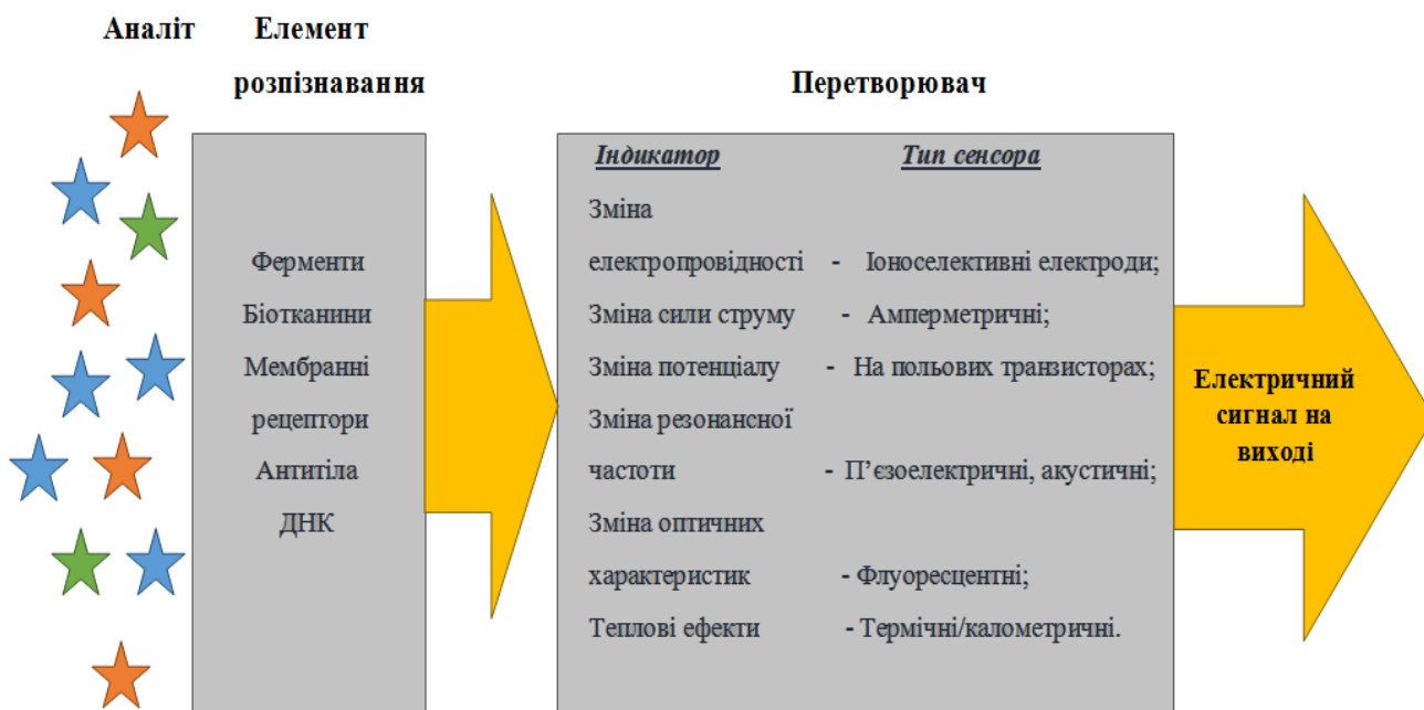
Рис. 1.14. Схематичне зображення процесу вимірювання медико-біологічних показників за допомогою різних типів імуносенсорів
