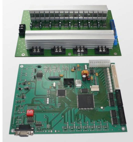
Рисунок 9 – Розроблені силовий модуль та модуль керування
