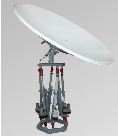
Рисунок 8 – Макет пристрою паралельної кінематичної структури Нехарод
