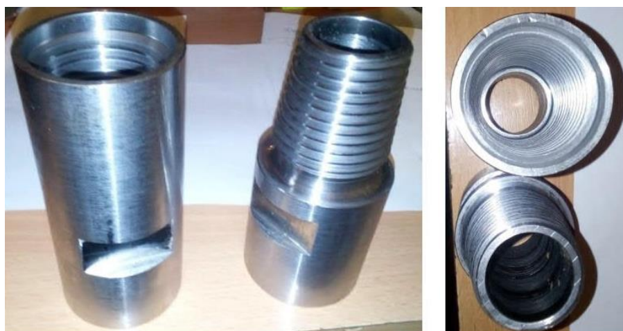
Рисунок 5.15 – Загальний вигляд зміцненої муфти (а) та ніпеля (б) бурового замка 3-50
