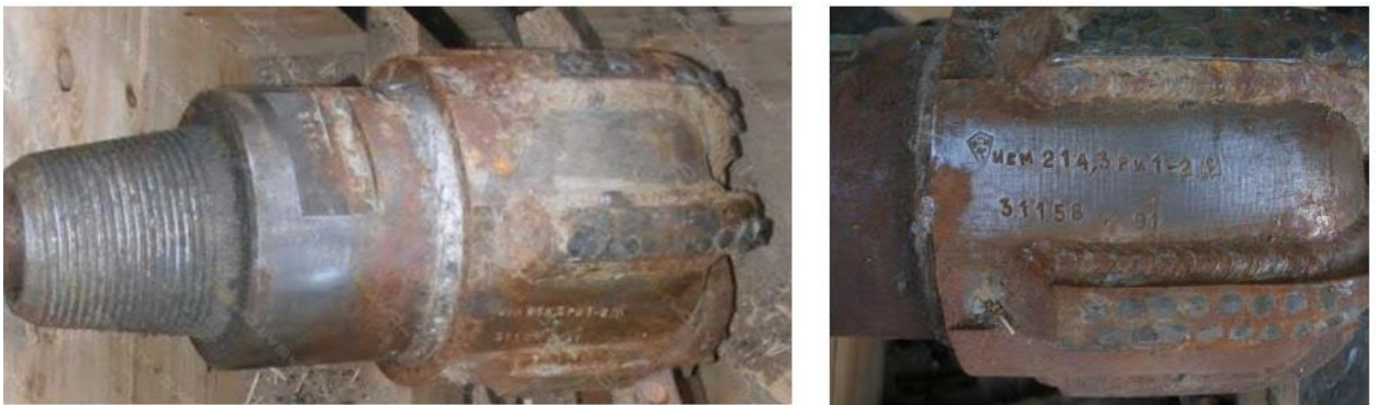
Рисунок 2.1 – Долота ріжуче-стираючої дії із привареними лопатями та нарізями (Джерело: фото із відкритих джерел Інтернет)
