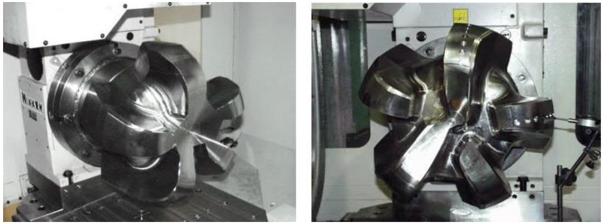
Рисунок 1.8 – Виготовлення суцільних сталевих корпусів доліт (Джерело: матеріали фірми Huges Christensen)
