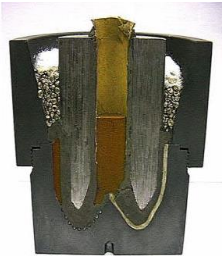
Рисунок 1.13 – Встановлення коронкового кільця в графітій формі для спікання
