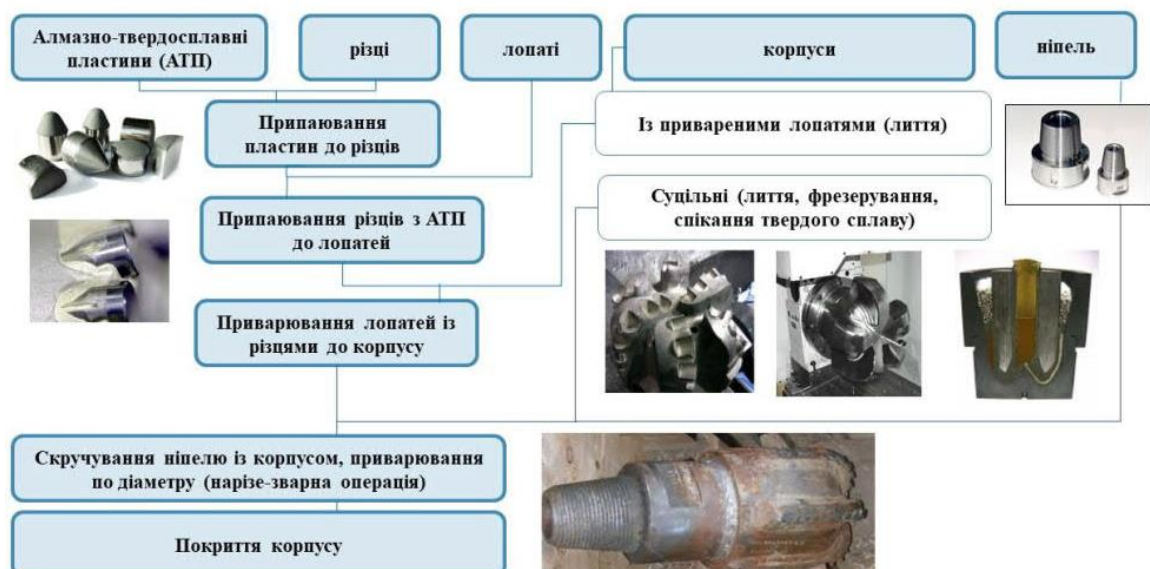
Рисунок 1.4 – Технологія виготовлення доліт ріжуче-стираючої дії
