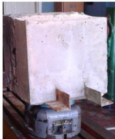
Рисунок 3.22 – Блок бетону, що імітує гірську породу
