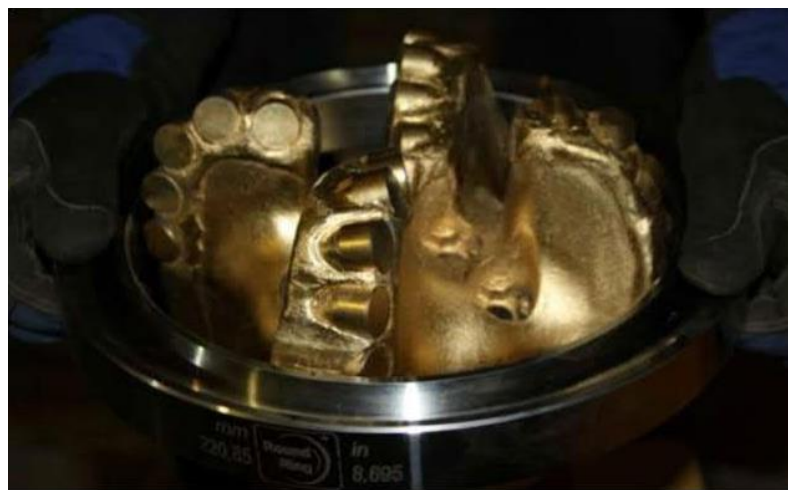
Рисунок 1.1 – Контроль прохідним кільцем-шаблоном Round Ring™ з внутрішнім діаметром 216,05 мм (номінальний діаметр долота – 215,9 мм (8 1/2"), висота кільця-шаблону Round Ring™ – 30 мм) [38]
