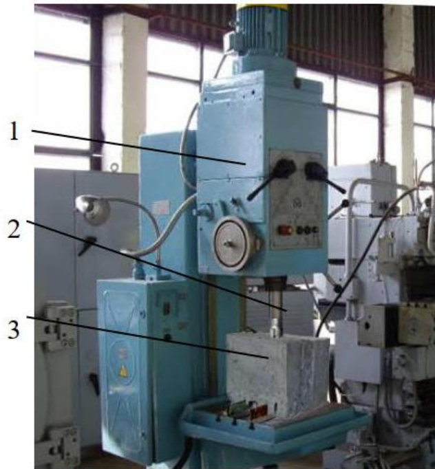
Рисунок 3.21 – Загальний вигляд експериментального стенду для випробовування бурових доліт: 1 – вертикально-свердильний верстат; 2 – бурове долото, 3 – блок гірської породи
