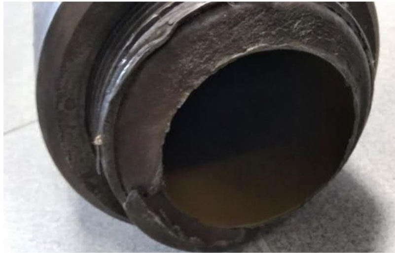
Рисунок 5.12 – Злам ніпелю бурильної труби, яка складалася за умов низьких температур (фото авторки)
