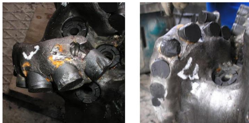
Рисунок 1.2 – Долото 11 5/8 DS 66Н виробництва Reed-Nucalог, гірські породи: аргіліти, кам'яні солі (родовища Новоукраїнське, Чутове, Розпашна) (фото з відкритих джерел Інтернет)
