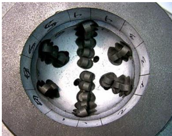
Рисунок 1.11 – Формування шаблону із графітовими вставками під різці
