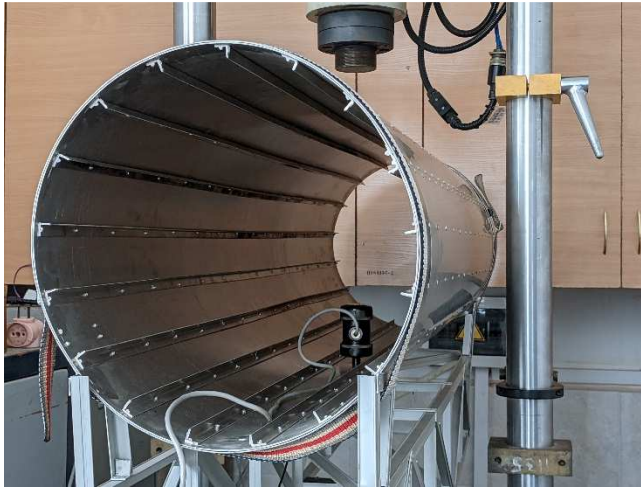
а) Спосіб кріплення датчика вимірювання амплітуди вимушених коливань
