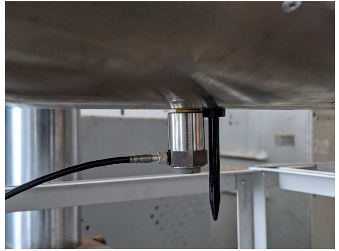
б) Спосіб кріплення датчика вимірювання віброшвидкості та віброприскорення вимушених коливань
