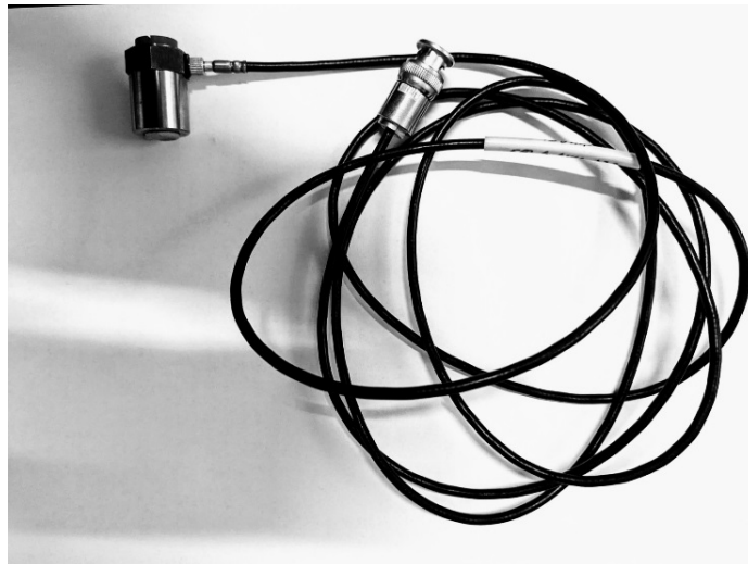
Рисунок 3.6. Віброметр ВВМ-201: а)-загальний вигляд; б)- датчик вимірювання віброшвидкості та віброприскорення
