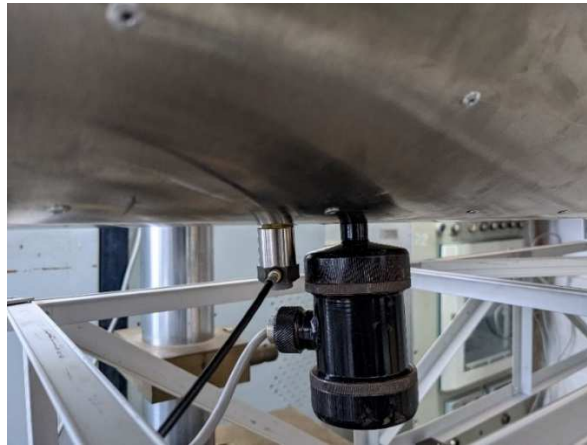
Рисунок 3.13. Кріплення датчиків вимірювання амплітуди та віброшвидкості і віброприскорення вимушених коливань моделі підсиленої оболонки з наповнювачем
