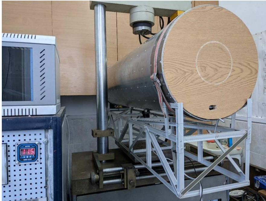
Рисунок 3.12. Загальний вигляд випробувальної установки при дослідженні вимушених коливань наповненої підсиленої моделі циліндричної оболонки
