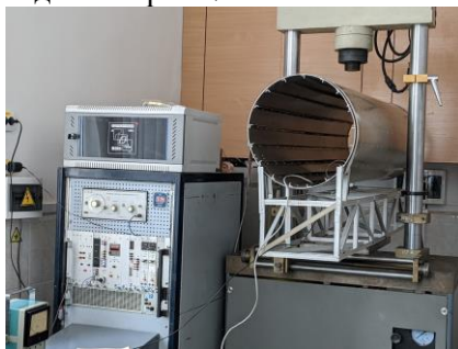
Рисунок 7. Експериментальна установка для дослідження навантаженості і втомної довговічності тонкостінних циліндричних оболонок при транспортуванні на базі випробувальної машини STM-100
