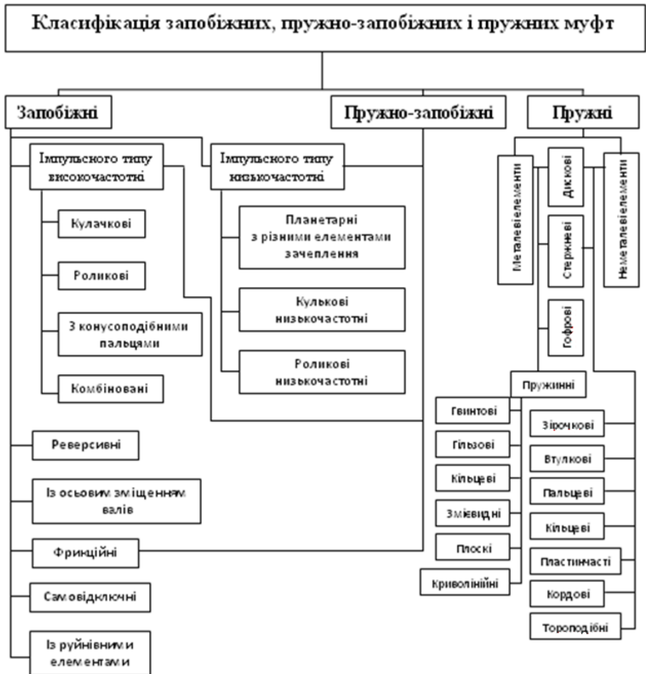
Рисунок 1.30 - Класифікація запобіжних, пружно-запобіжних і пружних муфт
