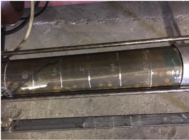
Рисунок 5.2 – Шкала перекривання шнеків стану для дослідження характеристик телескопічних гвинтових транспортерів
