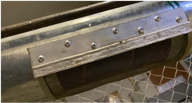
Рисунок 5.5 – Сепаруюча сітка, закріплена на рухомій в осьовому напрямку частині кожуха телескопічного гвинтового конвеєра
