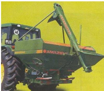
Рисунок 1.6 – Пристрій завантажувальний Amazone BS
