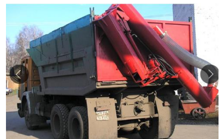
Рисунок 1.8 – Бортові розкладні шнеки ГРШ-300/4,5 та ГРШ-350/4,5
