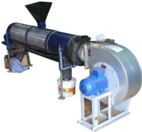
Рисунок 1.23 – Повітряно-шнековий сепаратор зерна з гвинтовим пневмоканалом [433]: а – принципова схема; б – загальний вигляд
