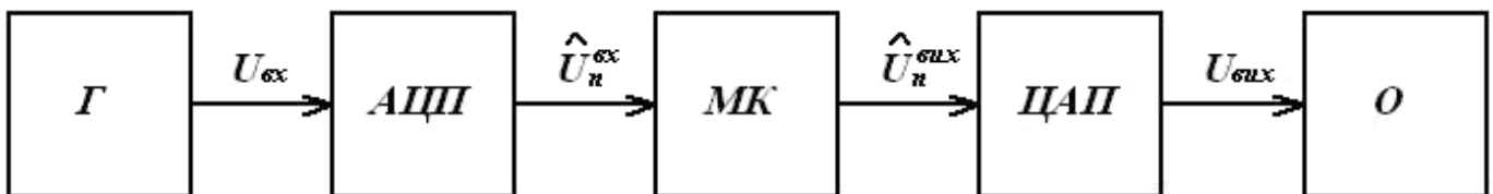
Рис. 3. Функціональна схема експерименту для верифікації комп'ютерної моделі магнітного ключа
