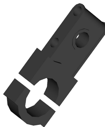
Рис.5. Загальний вигляд вуглепластикового підшипника променя мотовила
