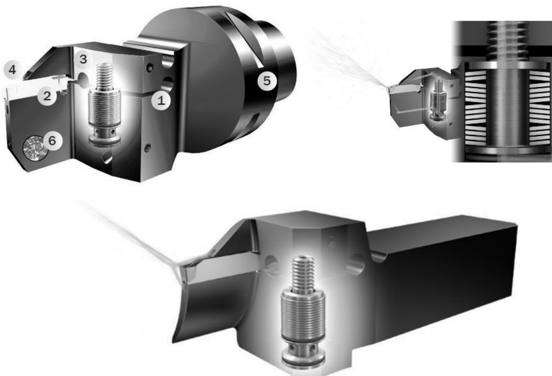
Рисунок 1.8 – Перспективні конструкції інструменту для проточування торцевих канавок
