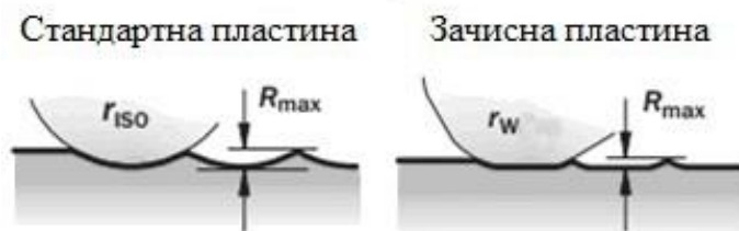
Рисунок 2.5 – Порівняння якості обробки при використанні стандартної пластини ( r_{ISO} ) і пластини із зачисним ефектом ( r_W )
