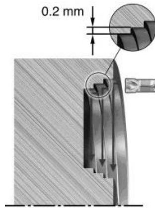
Рисунок 2.11 – Спосіб чорнової обробки торцевих канавок
