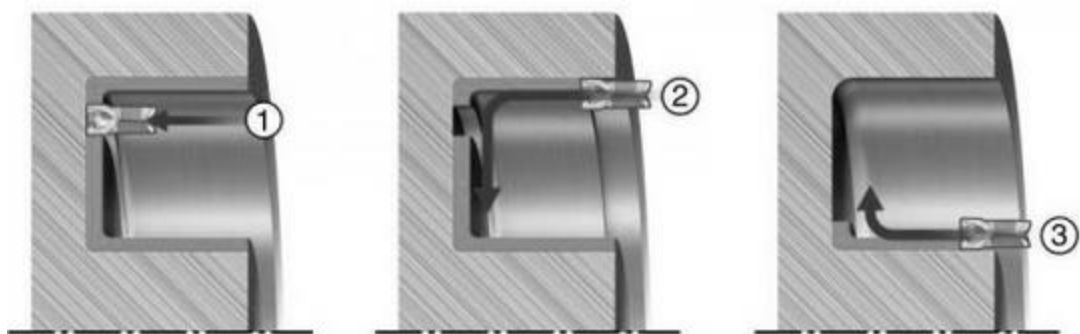
Рисунок 2.12 – Спосіб чистової обробки торцевих канавок
