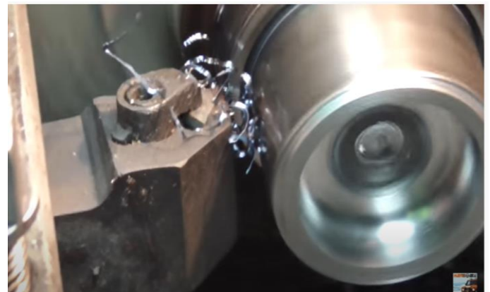
Рисунок 1.4 – Процес стружкоутворення під час виготовлення ступиці
