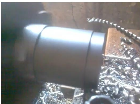
Рисунок 1.4 – Процес стружкоутворення під час виготовлення ступиці
