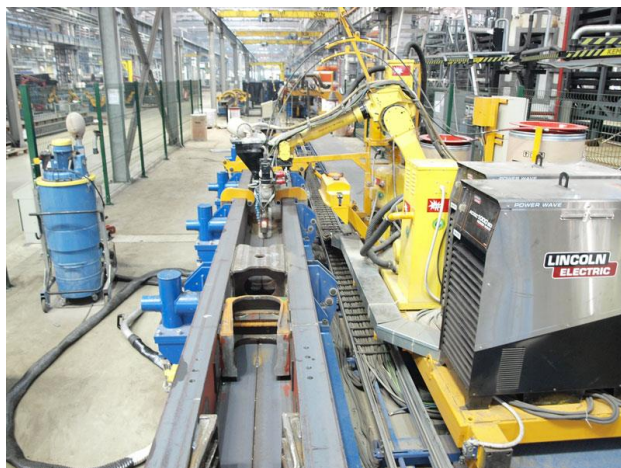
Рис. 3.8 Встановлення та приварювання ребр жорсткості до зетів [10 ]
