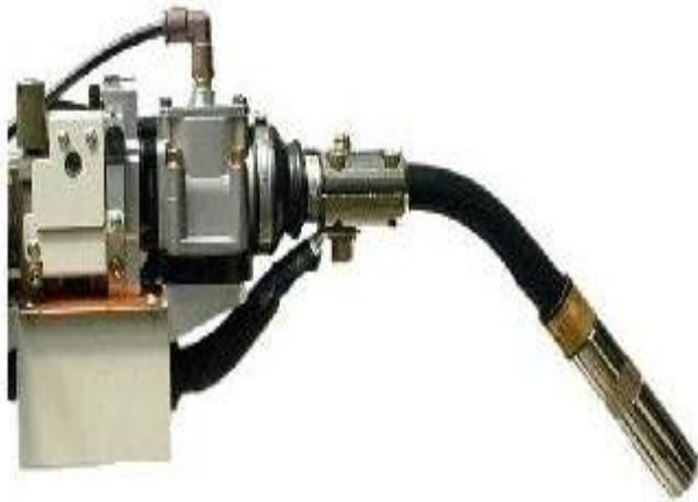
Рисунок 3.4 Загальний вигляд зварювальної головки типу SST
