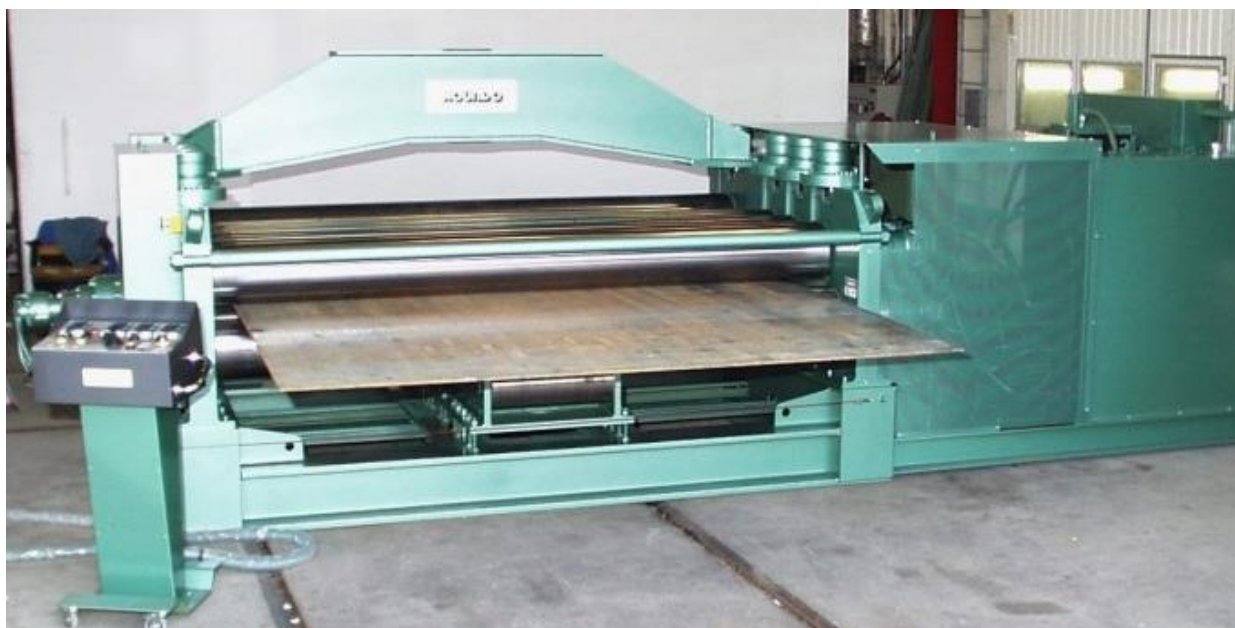
Рисунок 3.5 – Загальний вигляд листопрямильної машини PRH-310 (ROUNDО)
