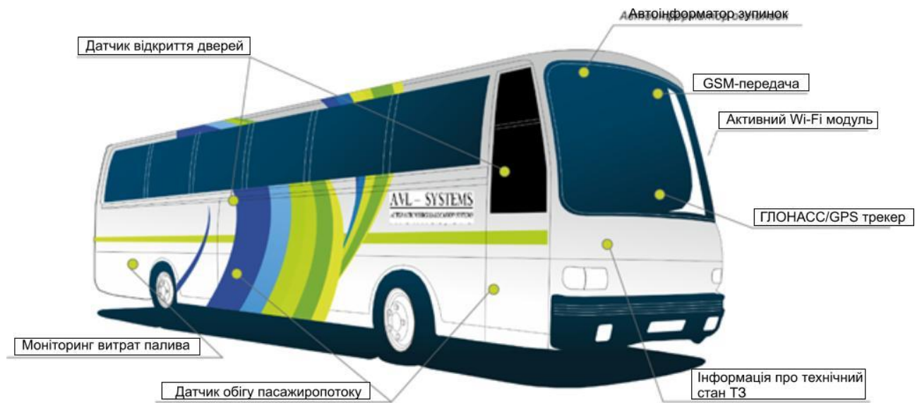
Рис. 3.8. Облаштування транспортного засобу
