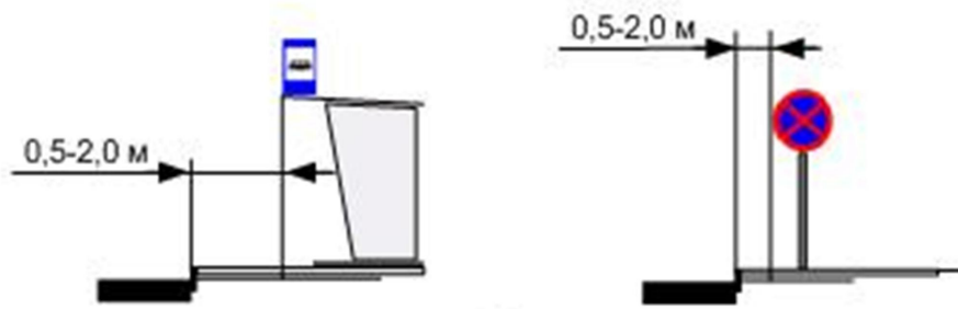
Рисунок 1.7 - Визначення проміжку встановлення знаків на краю від проїзної частини у містах
