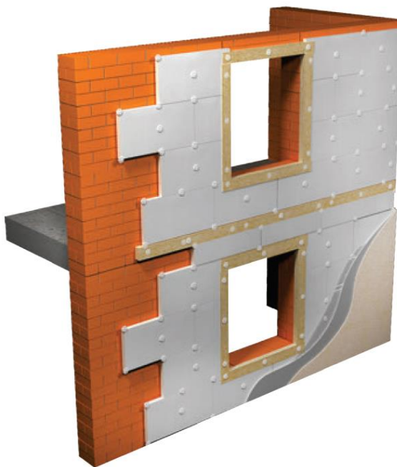
Рис. 4.1. Влаштування розмежувальних смуг з мінераловатних плит.
