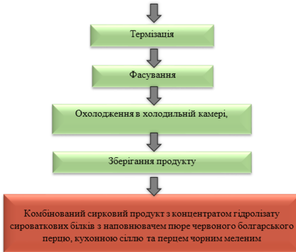
Рисунок 3.1 – Технологічна схема виготовлення комбінованого сиркового продукту з наповнювачем пюре червоного болгарського перцю, сіллю кухонною та перцем чорним меленим
