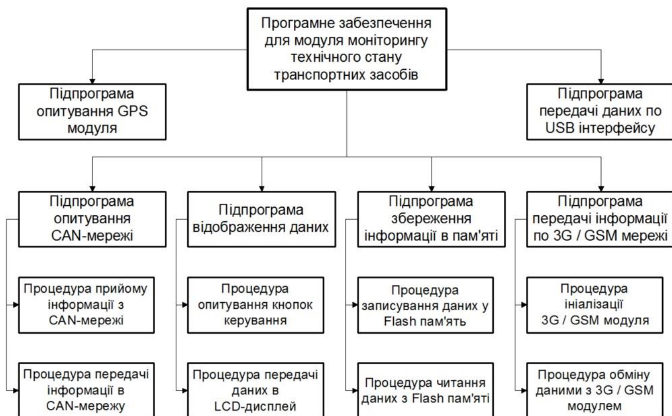
Рисунок 3.18 Структура програмного забезпечення для блока моніторингу технічного стану транспортних засобів
