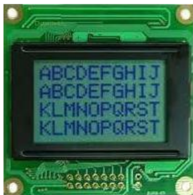
Рисунок 3.14 – Зовнішній вигляд рідкокристалічного дисплея BC1004A
