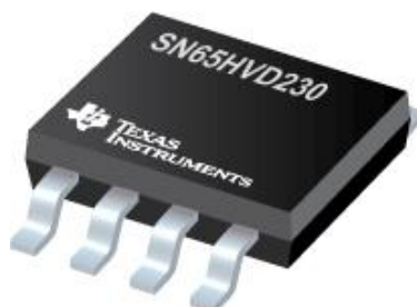
Рисунок 3.10 – Зовнішній вигляд CAN-модуля SN65HVD230
