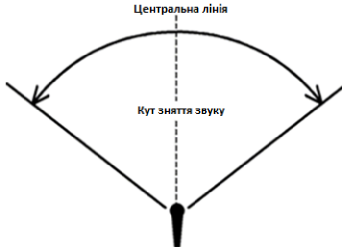
Рис. 1.1. Схема зняття звуку.
