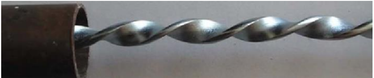
Рисунок 3.10. Статичні вставки із різним кроком спіралі
