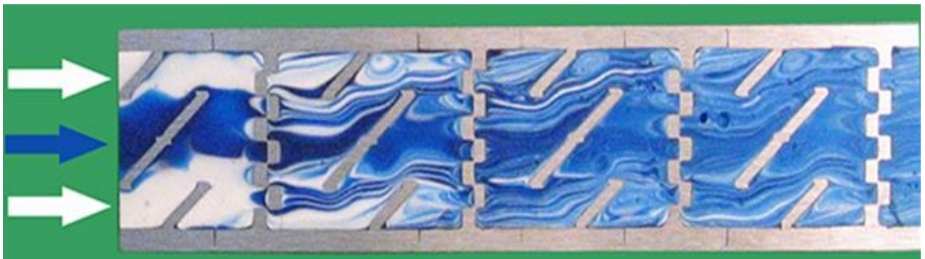
Рисунок 3.4. Режим руху середовищ в у звичайні трубці (а) та у трубці із вмонтованими статичними змішувальними елементами (б).
