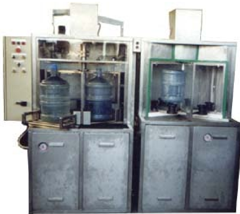
Рис. 1.7. Моноблок ополіскування, розливу і закупорювання ВАТ "СКБ Часового Станкостроения"
