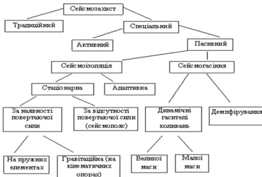
Рисунок 4.2 - Загальна класифікація систем сейсмозахисту споруд.
